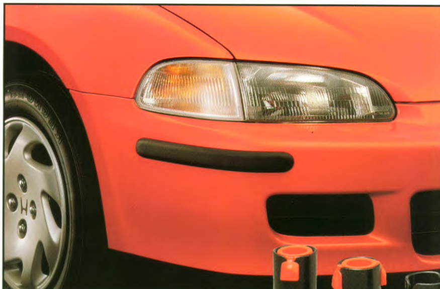
26. Stootrubbers Een set stootrubbers beschermt de hoeken van de bumpers tegen kleine parkeerschades.
