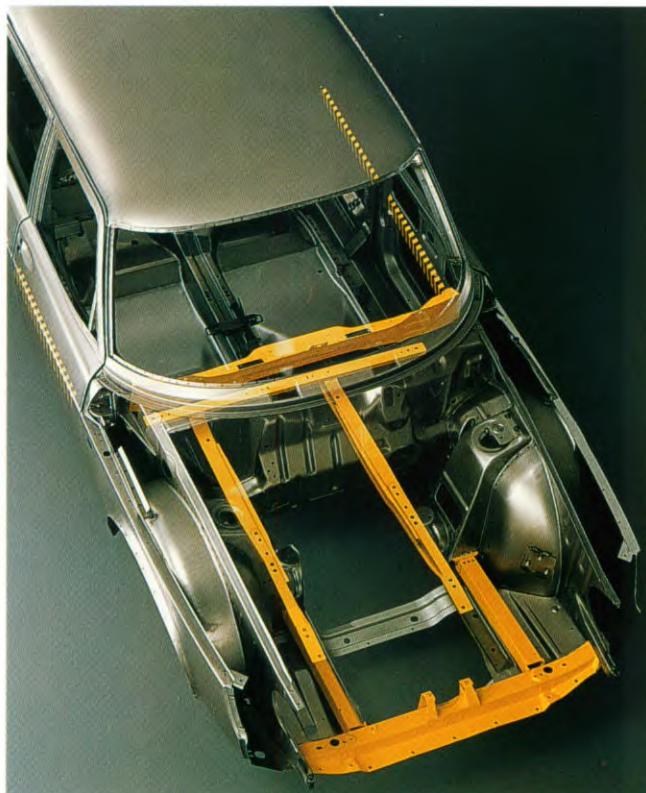
Versterkende balken Balken die de bij een frontale botsing vrijkomende krachten overbrengen op de wielkasten en de achterwaartse beweging van de motor tegenhouden.
