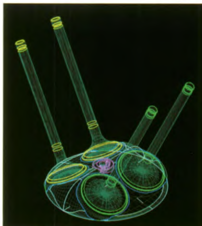
Evenals bovenstaande kleppen en verbrandingskamer zijn alle onderdelen van de Accord motor met behulp van computers ontworpen en getest.
