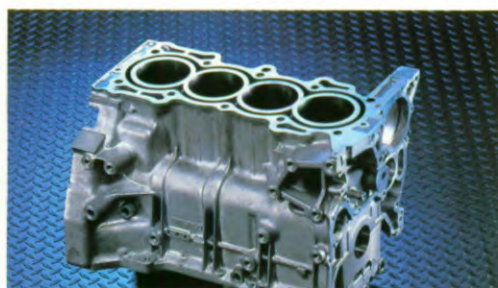
Sterk staaltje van vernuft: het nieuwe lichtmetalen motorblok.
