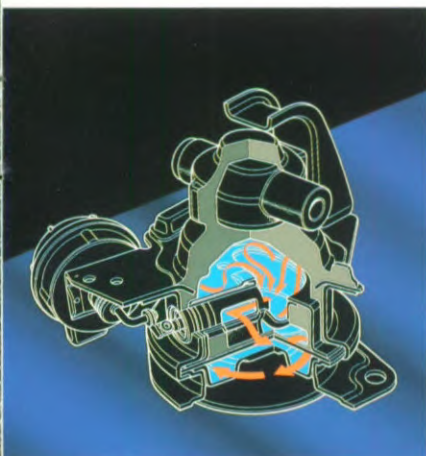
Een elektronisch gestuurde hydraulische motorophanging dempt trillingen bij stationair draaiende motor en bij het weggrijden. (Op automaat-versies).
