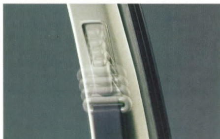
In hoogte verstelbare veiligheidsgordels op de voorstoelen.
