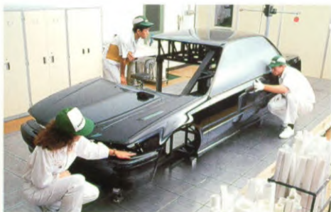
Inspectie van het zwart plastic model op ware grootte.
