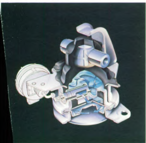
Elektronisch geregelde hydraulisch gedempte motorsteun.
