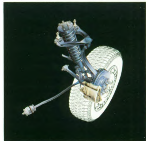
De onafhankelijke double wishbone voorwielophanging
