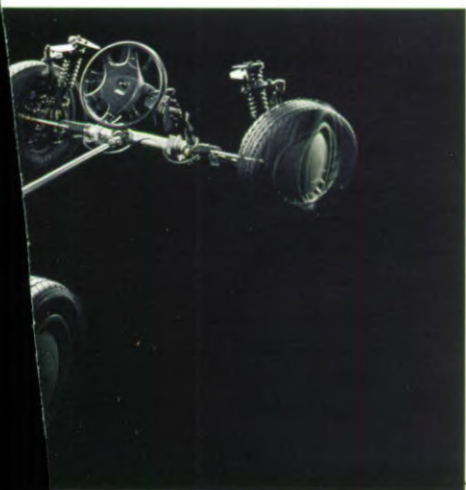
Honda: vierwielbesturing, waarbij de verdraaiing van de voor- en achterwielen bepaalt.
