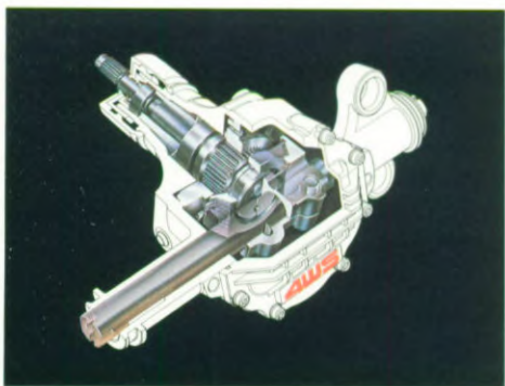
Het revolutionaire stuurhuis van het 4WS-systeem.
