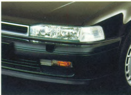
Sproeiers voor de koplampen. De voorspoiler verbetert de aërodynamiek.
