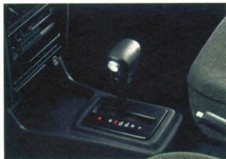
Volledig elektronisch gestuurde, automatische viertraps transmissie zorgt voor soepele prestaties bij alle toeren-tallen.
