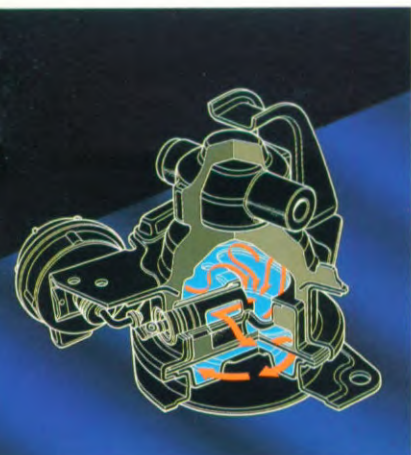
Een elektronisch gestuurde hydraulische motorophanging dempt trillingen bij stationair draaiende motor en bij het wegrijden. (Op automaat-versies).
