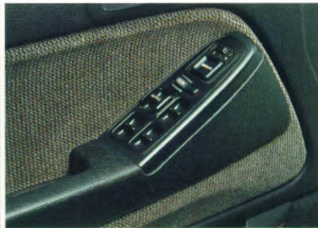
Met behulp van toetsen in de armsteunconsole zijn de zijspiegels en ramen makkelijk elektrisch te bedienen.
