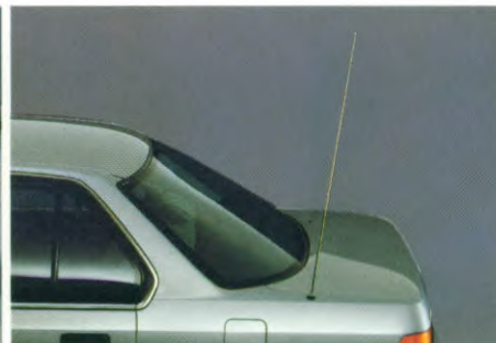
De elektrisch bediende antenne gaat automatisch omhoog of omlaag wanneer de radio aan of uit wordt gedaan.
