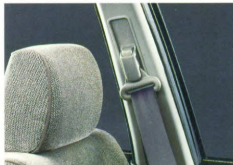
Verstelbare gordelverankeringen vóór geven meer comfort aan de inzittenden.
