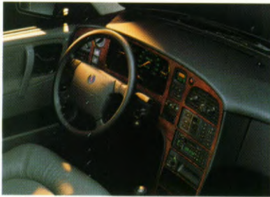
Het commandocentrum van de Saab 9000 CS. De instrumenten zijn in logische groepen ingedeeld en bevinden zich binnen handbereik.
