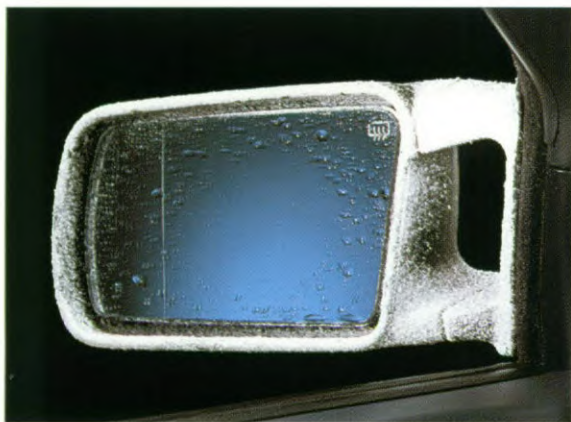
Elektrisch bediende en verwarmde buitenspiegels. Aan de bestuurderskant is een groothoekspiegel aangebracht, die de traditionele „dode hoek” achter de bestuurder opheft.
