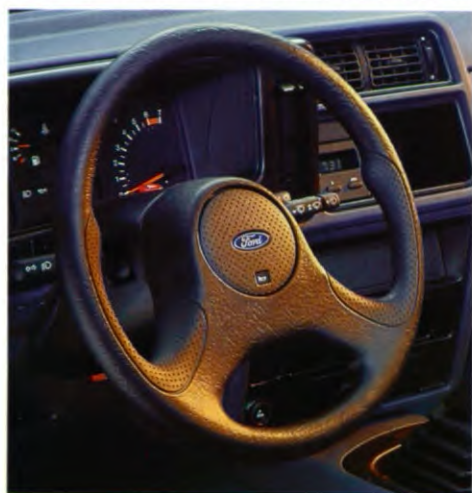
De Sierra S heeft een speciaal tweespaaks stuurwiel met uitsparingen voor de vingers en geperforeerde gripzones. Andere cockpit-details zijn een toerenteller en een regelbare instrumentenverlichting.
