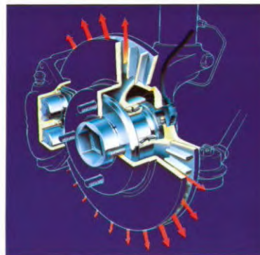
Geventileerde remschijf met een elektro-magnetische sensor voor het ABS-systeem
