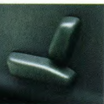
De tienvoudige elektrische verstelverstelling wordt bediend door schakelaars aan de zijzijde van de stoel.
