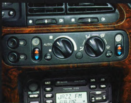
Airconditioning met Automatische Temperatuur Controle (ATC).
