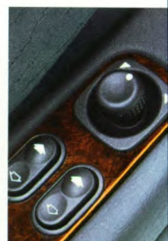
De bediening van de elektrische ramen en de buitenspiegels is comfortabel aangebracht in de armsteunen van de portieren.
