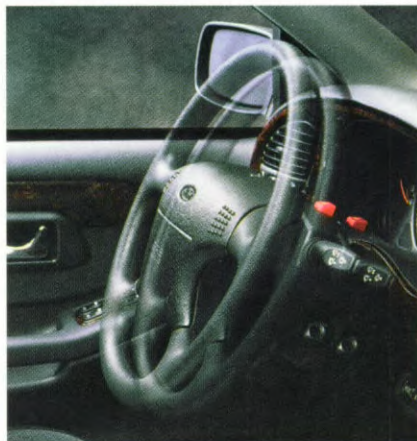
De stuurkolom van de Scorpio is verstelbaar in lengte- en hoogterichting (standaard Cruise Control niet afgebeeld).
