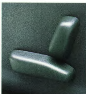
Tienvoudige elektrische stoelverstelling voorin is leverbaar als optie.
