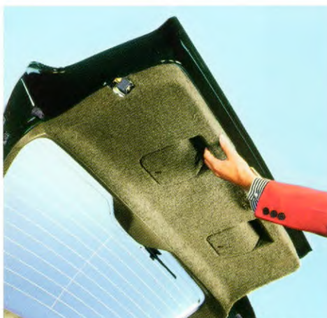
Een geïntegreerd handvat in de achterklep maakt het sluiten extra gemakkelijk.
