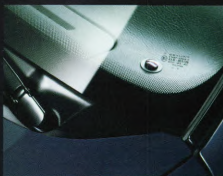
De zonnensensor: een intelligent onderdeel van het ATC-systeem in de Scorpio.
