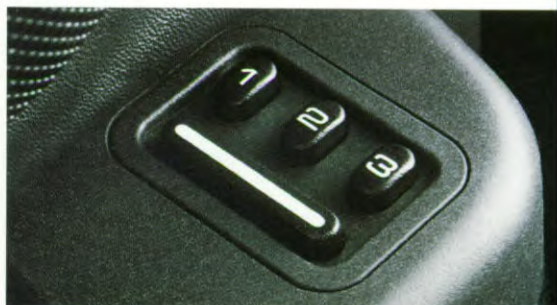
Als optie is een memory-functie leverbaar voor drie verschillende instellingen van de bestuurdersstoel en de buitenspiegels.
