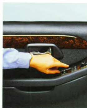
De elektrische raambediening heeft standaard een 'one-touch-down' functie aan de bestuurderszijde.
