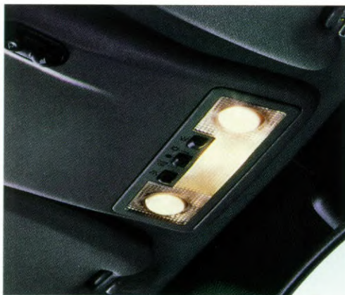
Indien dubbelwerkende portiervergrendeling is gemonteerd, gaat de interieurverlichting branden wanneer de sloten worden ontgrendeld. Daardoor kunt u het interieur goed overzien voordat u instapt.
