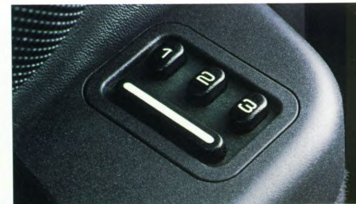
Als optie is een memory-functie leverbaar voor drie verschillende instellingen van de bestuurdersstoel en de buitenspiegels.
