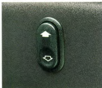
Elektrische hoogteverstelling voor de bestuurdersstoel is standaard in de Scorpio GLX en Ghia.
