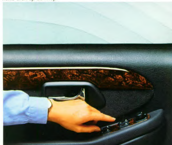
Indien uitgerust met de 'one-touch-down' functie kunnen de elektrisch bedienbare zijruiten volledig worden geopend met slechts één korte druk op de knop.
