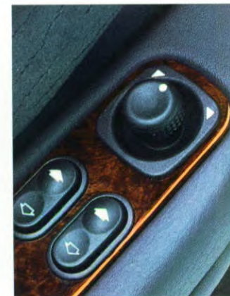
De bediening van de elektrische ramen en de buitenspiegels is comfortabel aangebracht in de armsteunen van de portieren.
