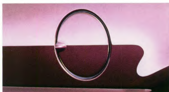
De centrale vergrendeling sluit en opent automatisch ook de tankdop.
