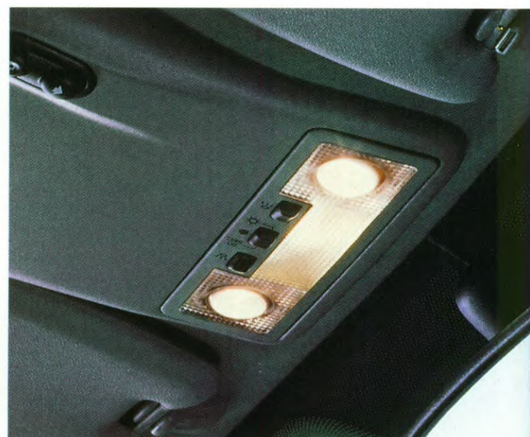
Indien dubbelwerkende portiervergrendeling is gemonteerd, gaat de interieurverlichting branden wanneer de sloten worden ontgrendeld. Daardoor kunt u het interieur goed overzien voordat u instapt.
