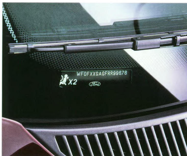
Het duidelijk zichtbare Voertuig Identificatie Nummer (VIN) onder de voorruit werkt preventief tegen autodiefstal.
