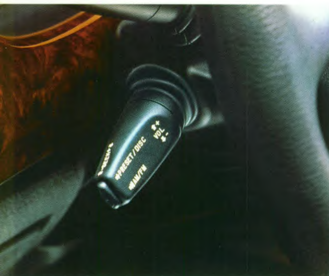
De afstandsbediening voor het audiosysteem, met een hendel aan de stuurkolom.
