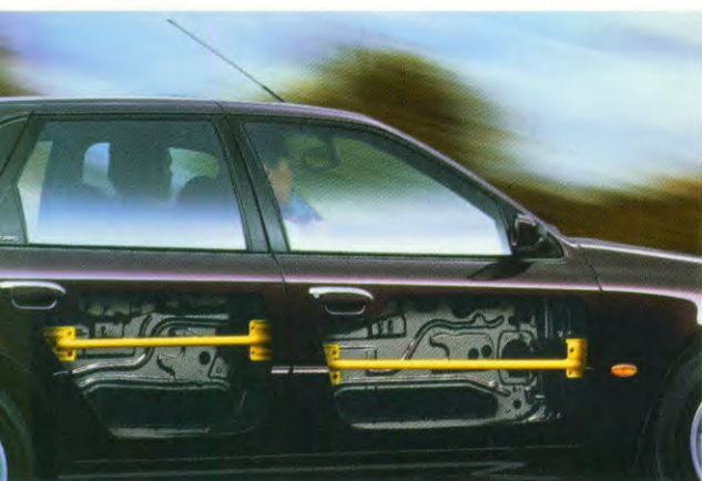
Stevige stalen balken zijn ingebouwd in alle portieren.
