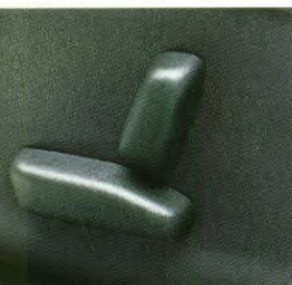
De tienvoudige elektrische stoelverstelling wordt bediend met schakelaars aan de zijkant van de stoel.
