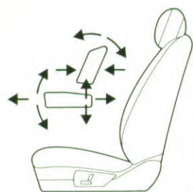
Tienvoudige elektrische verstelling van beide voorstoelen is als optie leverbaar in de Scorpio Ghia.
