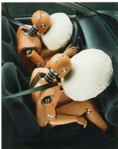
Een elektronische sensor houdt voortdurend de vertraging van de auto onder controle om ervoor te zorgen dat het airbag-systeem uitsluitend wordt geactiveerd bij een flinke botsing.
