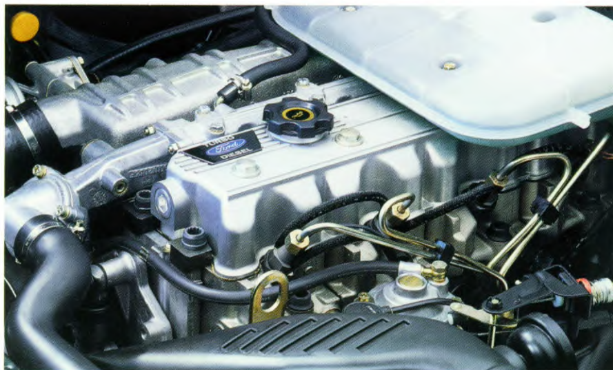
2,5 liter turbodieselmotor met 85 kW (115 pk).
