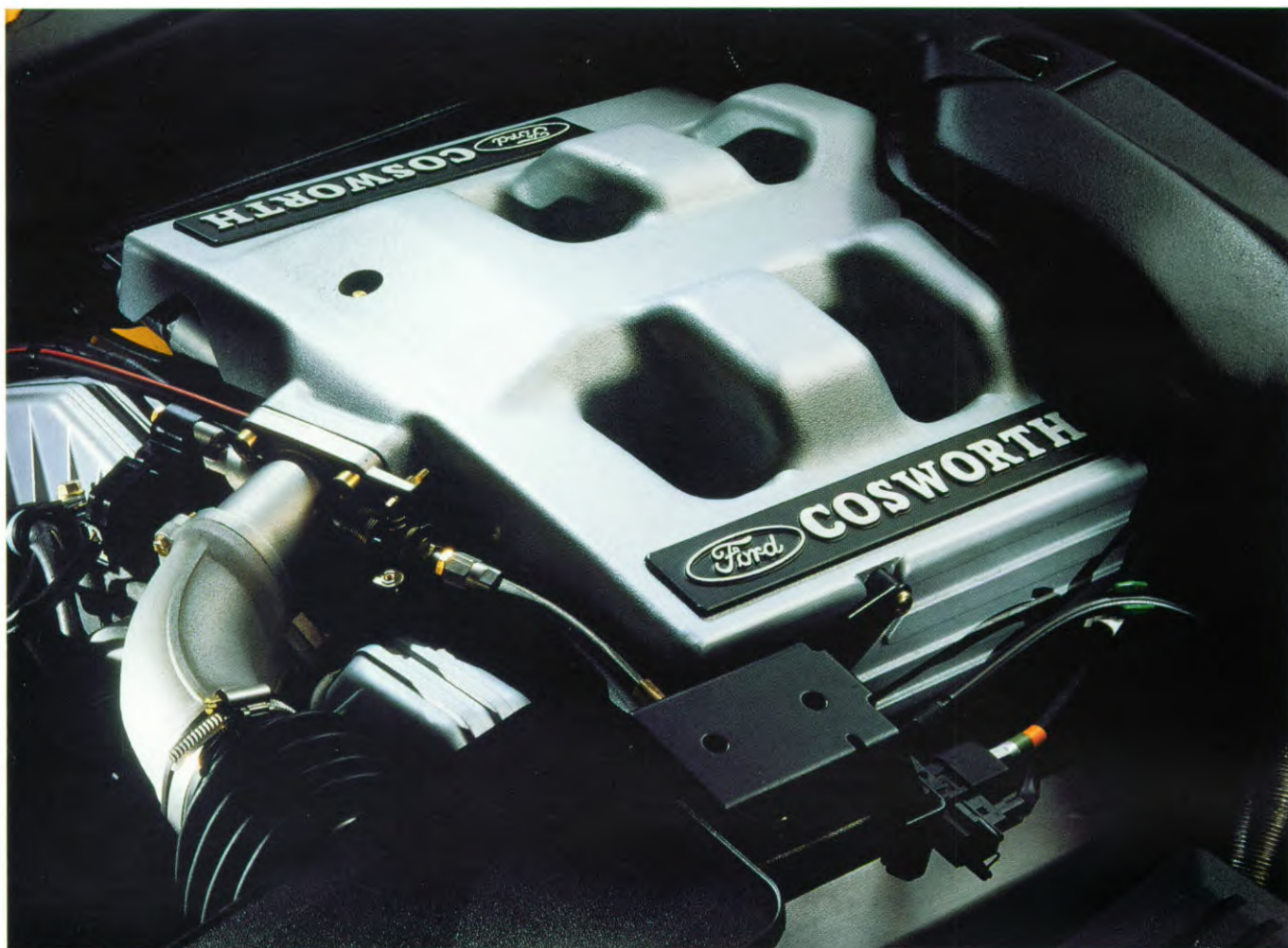
24V 2,9 liter EFI-motor met 143 kW (195 pk).
