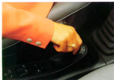
Uniek voor de Saab 900 is dat u bij het uitnemen van de contactsleutel als extra veiligheid de transmissie vergrendelt. Het contactslot bevindt zich uiteraard tussen de voorstoelen.
