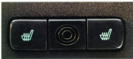
Verwarmde voorstoelen, standaard of optie, één van de vele dingen die Saab als eerste autofabrikant introduceerde. De sensor voor het automatische klimaatbeheersingssysteem (ACC) bevindt zich in het midden.
