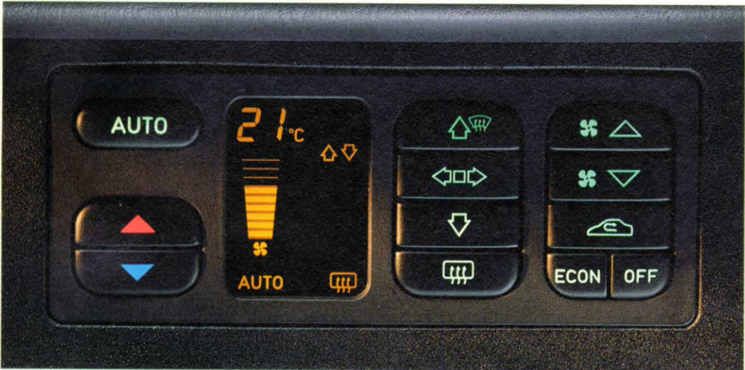
Het ACC systeem heeft een groot aantal functies en werkt automatisch zonder dat u er naar om hoeft te kijken. (Afgebeeld is het ACC paneel in de nieuwe Saab 900).
