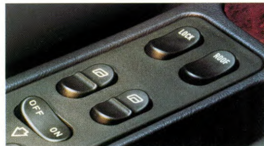
In de Saab 9000 is de schakelaar voor de centrale deurvergrendeling tussen de voorstoelen aangebracht, zodat eventuele lastige individuen snel buiten de deur gehouden kunnen worden.
