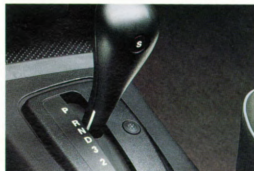
De selectiehendel op de 9000 serie met automatische transmissie ligt goed in de hand en is voorzien van internationale standaardsymbolen die de geselecteerde versnelling duidelijk aangeven. De symbolen zijn bij het donker verlicht. Hetzelfde geldt voor de 900 serie met automatische transmissie. De selectiehendel heeft twee extra knoppen: een voor het Sport programma en een voor het Winter programma. Wanneer geen van beide knoppen zijn ingedrukt, werkt de transmissie normaal.
