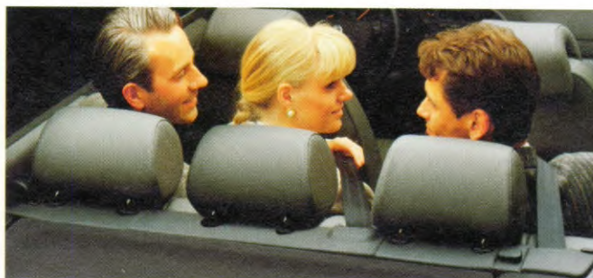
De stevige balk aan de bovenkant van de achterbank vormt een integraal onderdeel van de veiligheidskooi in de nieuwe Saab 900. Wanneer de rugleuning volledig is neergeklapt, houdt deze balk de bagage tegen.
