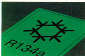
In de nieuwe Saabs wordt geen CFC R12 gebruikt. Het ACC systeem maakt gebruik van R134a, een koelmiddel dat geen chloor bevat en dus ozonvriendelijk is.
