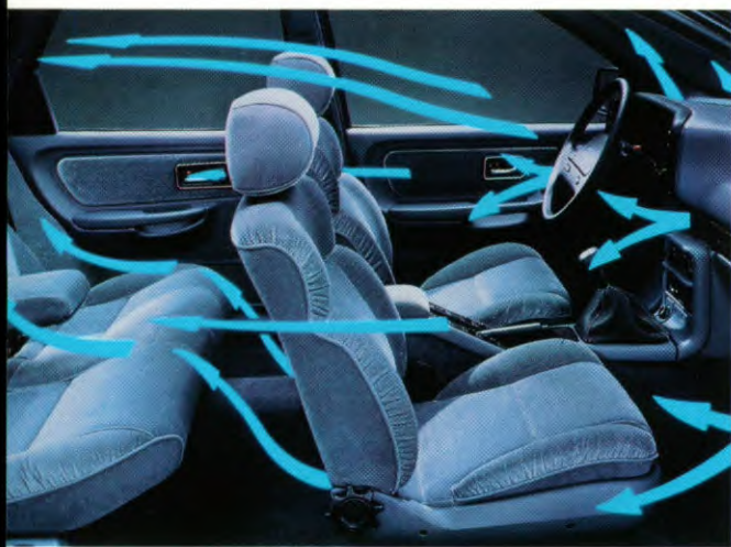
Het geavanceerde ventilatiesysteem van de Scorpio.
