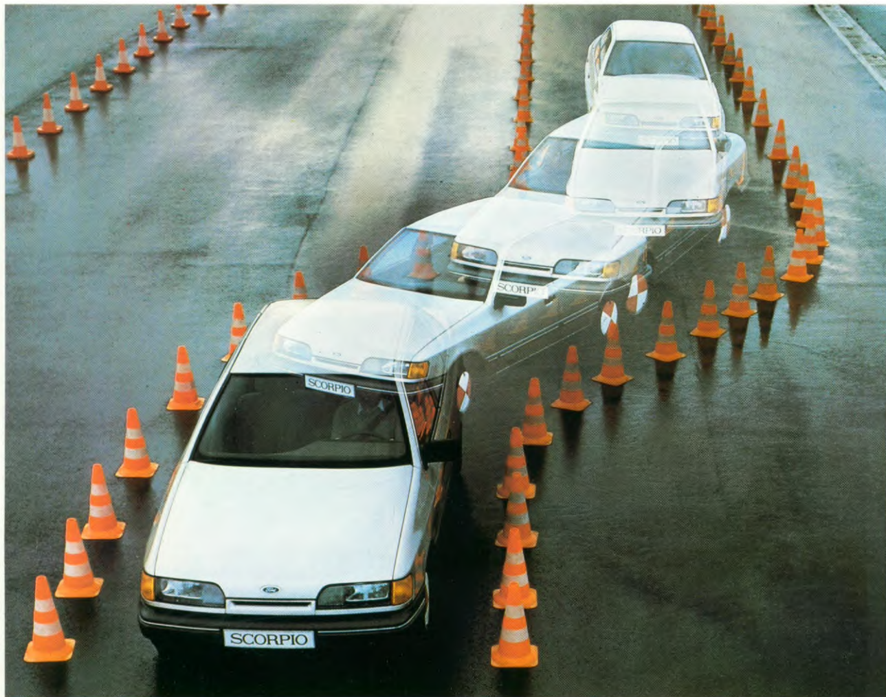
Stroboscoop-demonstratie van een zeer krachtige remmanoeuvre met een Scorpio. De wagen blijft op stuurcorrecties reageren.
