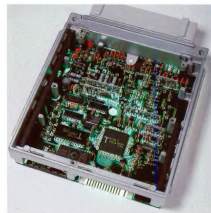
Een blik in het inwendige van de EEC IV elektronische regeleenheid.
