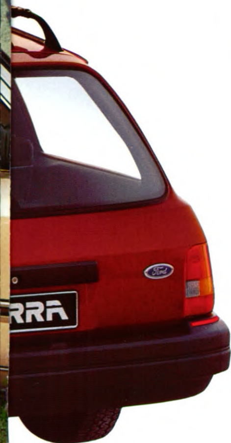
Bij geheel neergeklapte achterbank beschikt de Sierra stationwagon over een immense laadruimte van 1346 mm breedte en 1880 mm lengte.
