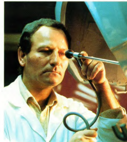
Controle van een holle ruimte na behandeling met antiroest was.
