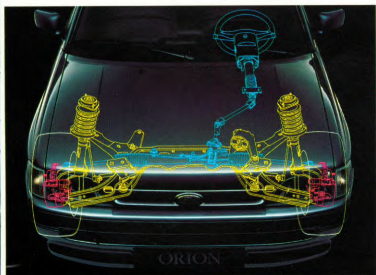
Stuurinrichting met variabele overbrengingsverhouding.
