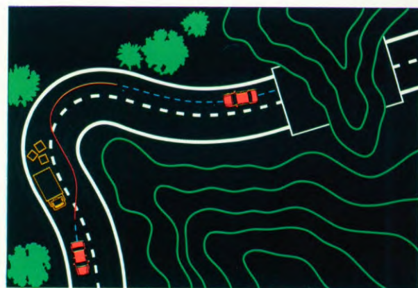
Het als optie leverbare Anti-Blokkeer remSysteem (ABS) draagt ertoe bij dat de auto bij een noodstop normaal bestuurbaar blijft.
