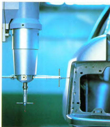
Een computergestuurde kop controleert alle maten van de carrosserie.
