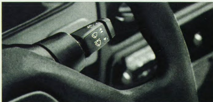
Schakelaarhandels op de stuurkolom vereenvoudigen de bediening van lichten, knipperlichten en ruitewissers.
