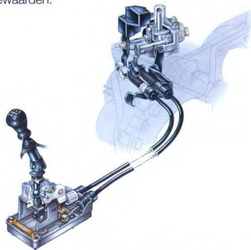
De verbeterde MTX handgeschakelde vijfversnellingsbak met nieuwe kabelbediening.
