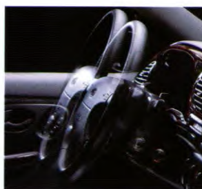
De stuurkolom is in hoogte en lengterichting verstelbaar.
