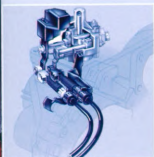
De handgeschakelde MTX75 transmissie met 5 versnellingen en kabelbediening.
