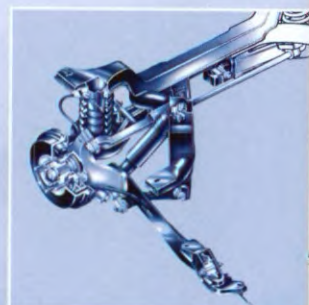
De SLA-achterwielophanging van de Mondeo stationwagon zorgt voor een optimale handelbaarheid, een optimaal rijcomfort en een buitengewoon grote laadruimte.
