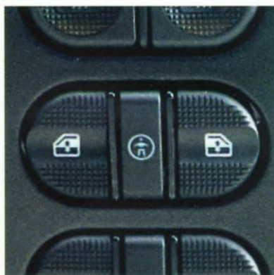
Blokken van de elektrische ramen achter.
