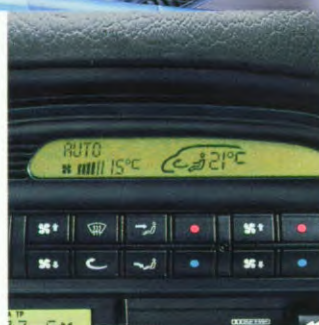
Dubbele airconditioning met ATC.
