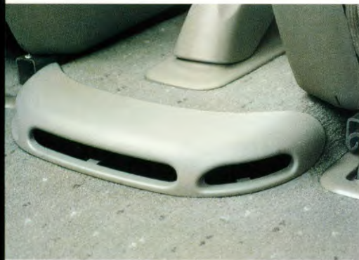
Uitstroomopeningen op de vloer voor de tweede rij.
