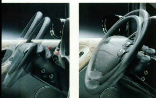
De stuurkolom in de Galaxy is axiaal en verticaal verstelbaar.
