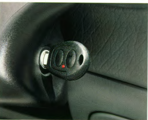
PATS elektronische startblokkering werkt via de sleutel.
