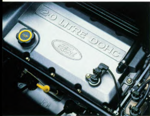
2,0-liter DOHC motor met 85 kW (115 pk).
