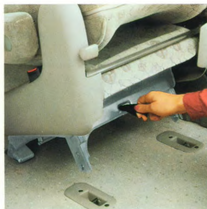
Door een gemakkelijk ontgrendelsysteem kunnen de stoelen op de tweede en derde rij snel naar voren worden gevouwen.
