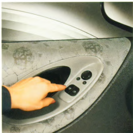
Elektrische bediening van de voorportierruit.
