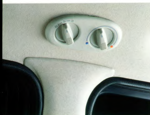
De bediening van de verwarming achterin is gemonteerd boven de B-stijl.
