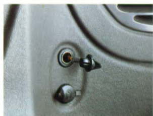
12-volt aansluitpunten achterin.
