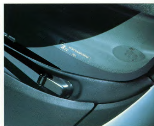
Het chassisnummer van de Galaxy is duidelijk zichtbaar achter de voorruit aangebracht (VIN).
