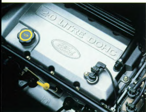
2,0-liter DOHC motor met 85 kW (115 pk).
