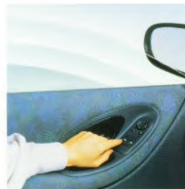
Elektrische bediening van de voorportierruit en van de verwarmbare buitenspiegels.
