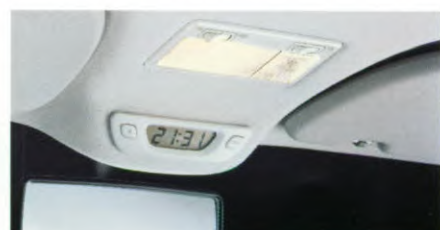
Interieurverlichting met uitschakelvertraging.
