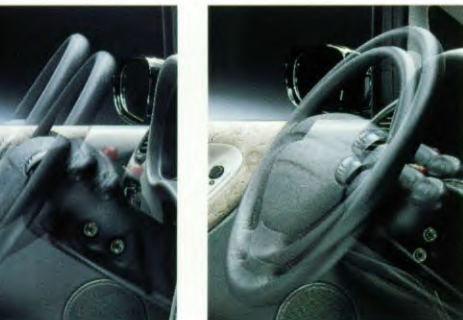
De stuurkolom in de Galaxy is axiaal en verticaal verstelbaar.
