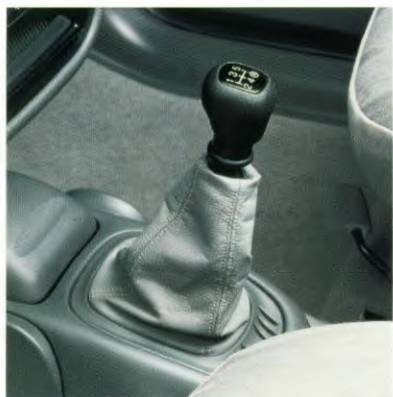
VXT 75 handgeschakelde vijfversnellingsbak.
