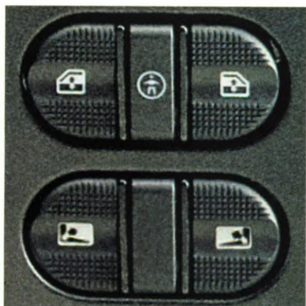
Elektrische bediening van de uitstelbare achterste zijruiten.
