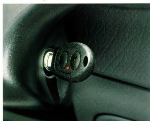
PATS elektronische startblokkering werkt via de sleutel.
