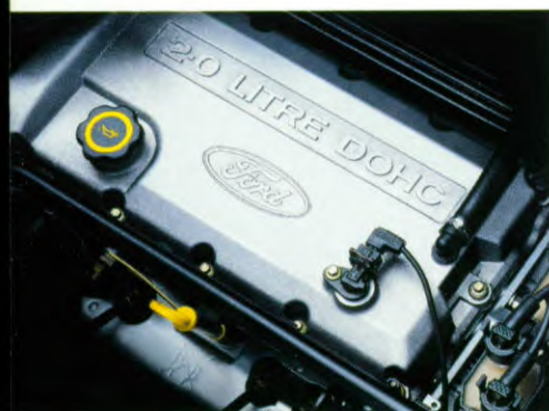
2,0-liter DOHC motor met 85 kW (115 pk).
