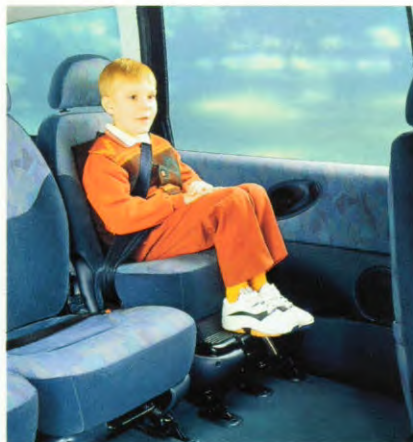
KIND: Wanneer wordt getrokken aan de lus onder het zitkussen komt de zitting omhoog, zodat de stoel in combinatie met de gewone gordel kan worden gebruikt voor jonge kinderen.
