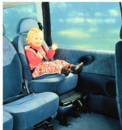
BABY: Behalve de verhoogde zitting kan nog een extra zitkussen uit de rugleuning naar voren worden getrokken. Hierdoor komt ook een vijfpunts gordel vrij voor baby's tot 12 maanden.
