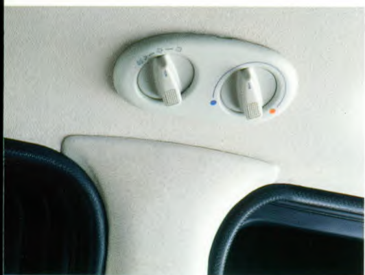
De bediening van de verwarming achterin is gemonteerd boven de B-stijl.
