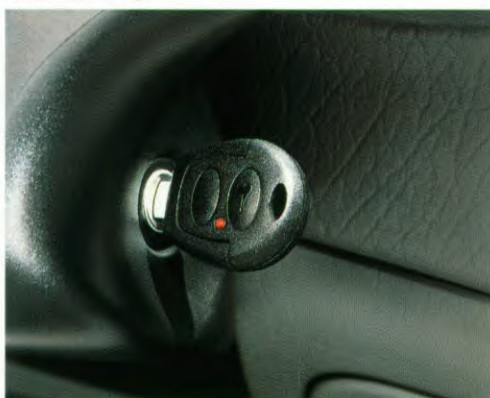
PATS elektronische startblokkering werkt via de sleutel.
