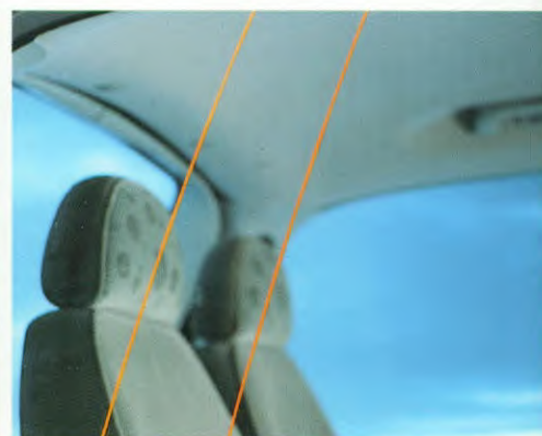
Als bescherming tegen vandalisme is de antenne van de Galaxy aangebracht in een van de achterste zijruiten. Doordat de antenne als dunne draad in het glas is geïntegreerd, hindert deze het zicht niet.
