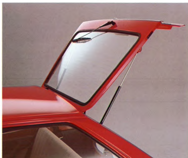
Achterdeur, met twee gasdruksteunen, doorlopend tot op de laadvloer. (Wis/was installatie tegen meerprijs).
