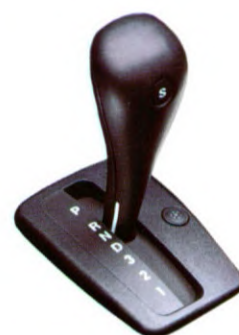
De nieuwe automatische viertraps versnellingsbak met drie standen: Normaal, Sport en Winter.
