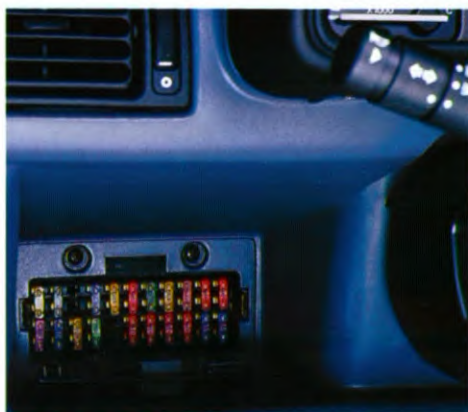
De zekeringen zijn gemakkelijk bereikbaar.
