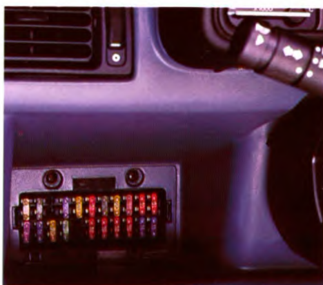
De zekeringen zijn gemakkelijk bereikbaar.
