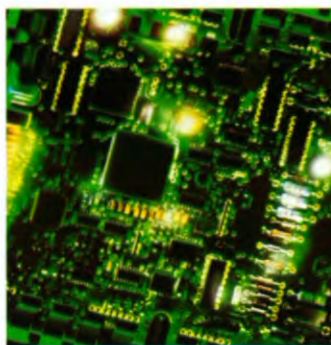
Het motormanagementsysteem Ford EEC V van de nieuwste generatie.
