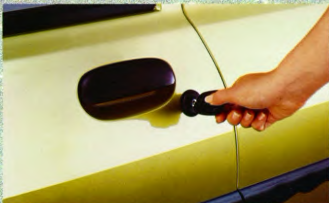
De dubbele vergrendeling maakt het onmogelijk de portieren te openen, zelfs niet van binnenuit via een ingeslagen ruit.
