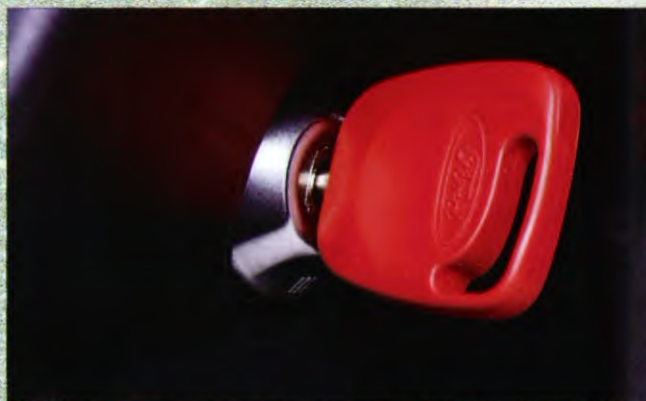
Dankzij de PATS elektronische startblokkering (optie) kan de motor van de Fiesta alleen starten met de bijbehorende contactsleutel met ingebouwde elektronische code.
