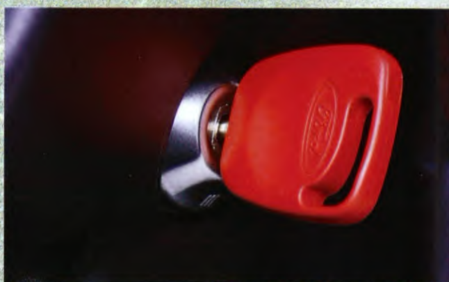
Dankzij de PATS elektronische startblokkering (optie) kan de motor van de Fiesta alleen starten met de bijbehorende contactsleutel met ingebouwde elektronische code.
