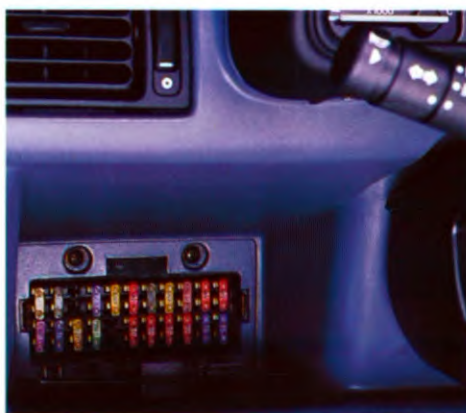
De zekeringen zijn gemakkelijk bereikbaar.
