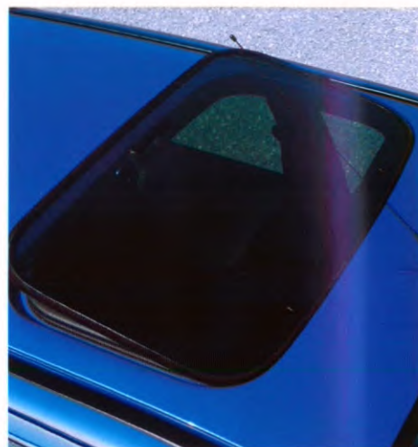
Het zowel uitklapbare als uitneembare warmtewerend zonnedak kan af fabriek worden besteld of door de dealer worden gemonteerd.
