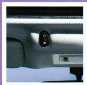
Een door bestuurder en passagier gemakkelijk te bereiken tiptoets bedient het canvas vouwdak van de Calypso.
