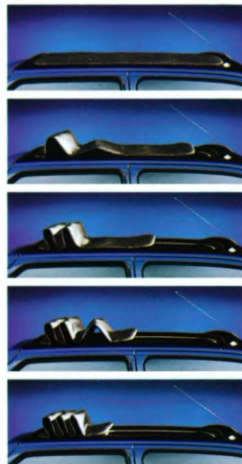
Een simpele druk op de knop manoeuvreert het elektrisch bedienbare vouwdak van de Calypso in elke gewenste positie, van volledig open tot vast en zeker gesloten.
