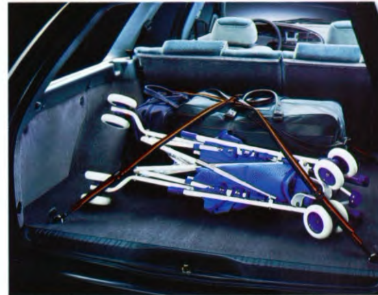
Bevestigingsogen zorgen dat de lading op zijn plaats blijft en bevorderen daardoor de veiligheid van de inzittenden. Bijpassende spanbanden zijn leverbaar als optie.
