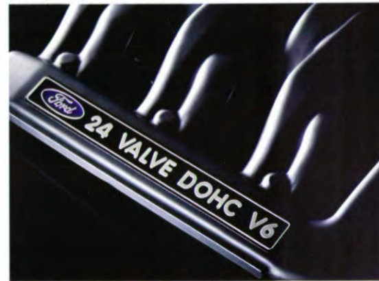
De krachtige 2,5-liter V6 24V DURATEC motor heeft een vermogen van 125 kW (170 pk).
