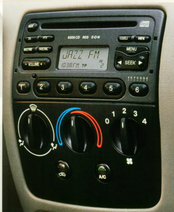
Airconditioning i.c.m. luchtrecirculatie is als optie leverbaar (m.u.v. de Fiesta 1.3 8V).
