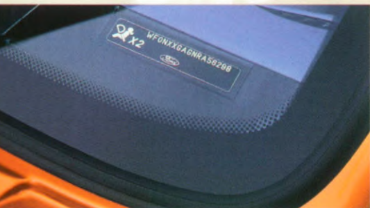
Het zichtbaar achter de voorruit geplaatste chassisnummer (VIN) werkt preventief tegen autodiefstal.
