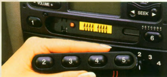
Het afneembaar front van de Easy Sound audiosystemen kan worden verwijderd om diefstal te voorkomen.
