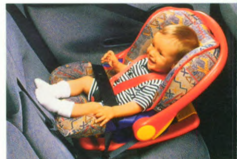
Babyzitje. Tegen de rijrichting in geplaatst, voor baby's van 0 tot ongeveer 9 maanden tot 10 kg.
