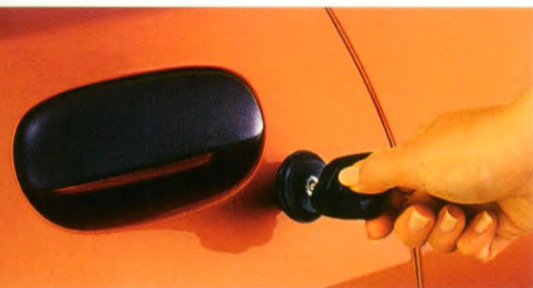
Dubbele vergrendeling helpt te voorkomen dat portieren van buitenaf worden geopend, zelfs wanneer een ruit is ingeslagen.
