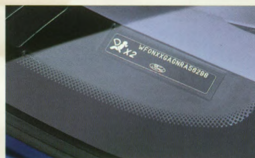
Het chassisnummer is van buitenaf duidelijk zichtbaar aangebracht op het dashboard. Een effectieve, preventieve maatregel.
