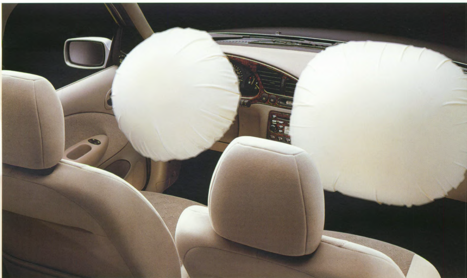
De Ford Fiesta met voor-airbags is ontworpen om in samenwerking met de gordels het beschermen van de hoofden en gezichten van de inzittenden.
