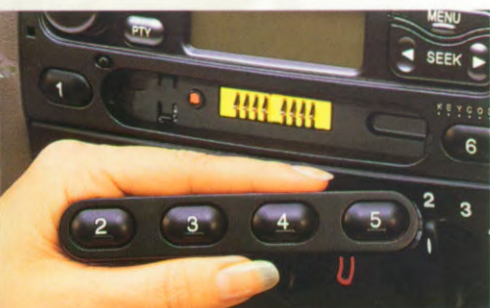
Alle nieuwe Ford-audiosystemen zijn voorzien van een gemakkelijk te verwijderen frontpaneel om diefstal te ontmoedigen. Eenmaal verwijderd kan het frontpaneel gemakkelijk worden meegenomen in uw binnenzak of handtas.
