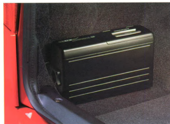
CD-WISSELAAR. Wanneer uw Saab is voorzien van het Saab Audio Systeem kunt u een CD-wisselaar voor 6 CD's toevoegen.
