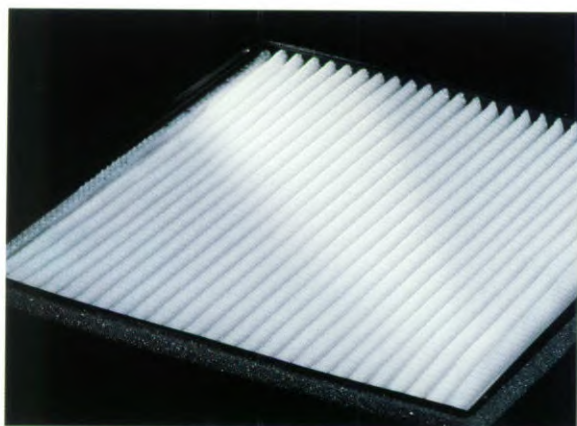
LUCHTFILTER. Het elektrostatische luchtfilter beschermt het interieur tegen stof, roet, stuifmeel en andere deeltjes in de lucht tot een grootte van circa 0,004 mm.
