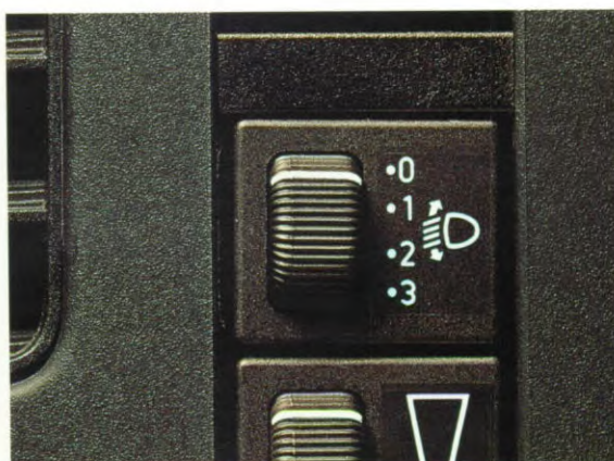
KOPLAMPAFSTELLING. Voor wanneer de auto zwaar beladen is. Zorgt dat u een goed zicht op de weg houdt en voorkomt het verblinden van tegenliggers.
