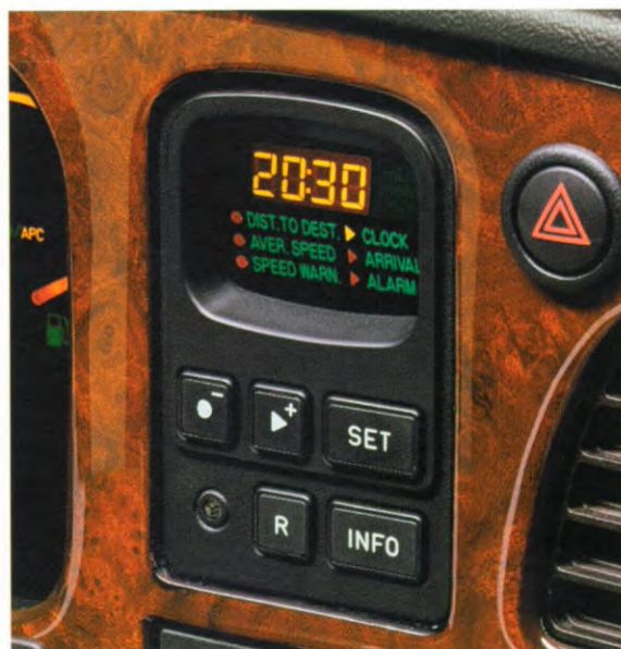
De Saab Car Computer (SCC) helpt u bij het plannen van uw reis. De SCC geeft niet alleen de tijd aan maar ook de gemiddelde snelheid, de resterende afstand tot de plaats van bestemming, verwachte aankomsttijd, enz.
