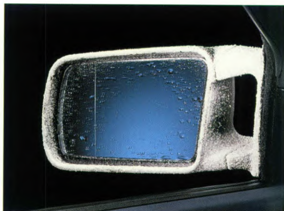
ELEKTRISCH BEDIENDE EN VERWARMDE BUITENSPIEGELS. De spiegel aan de bestuurderszijde is van het groothoektype, dat de bekende dode hoek achter de bestuurder opheft.
