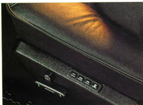
ELEKTRISCH BEDIENDE VOORSTOELEN. In 8 standen elektrisch verstelbaar, met drie geheugeninstellingen voor de bestuurdersstoel.
