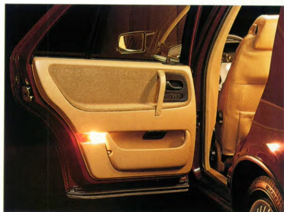
INSTAPVERLICHTING. De witte verlichting in de portieren vergemakkelijkt het in- en uitstappen in het donker, terwijl de rode verlichting het achteropkomend verkeer waarschuwt dat er een portier openstaat.
