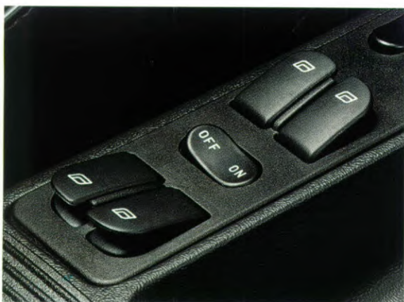
ELEKTRISCH BEDIENDE RAMEN. De werking van de ergonomisch gevormde toetsen is uiterst logisch: indrukken om de ramen te openen en omhoog brengen om de ramen dicht te doen. Kinderveiligheidssloten voor de zijramen achter.
