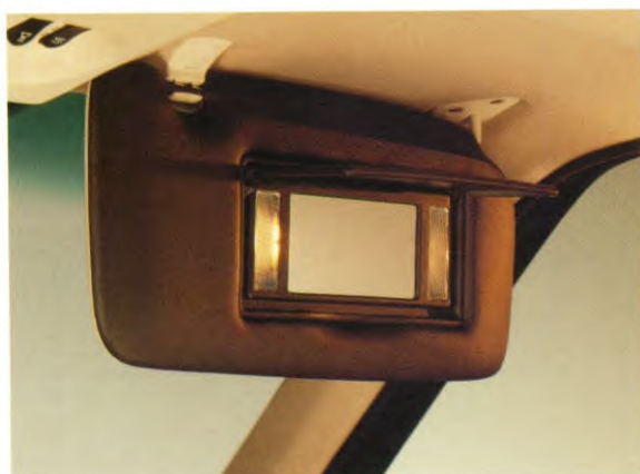
MAKE-UP SPIEGELS. Elke zonneklep is voorzien van een verlichte spiegel. Zodra u de klep neerklappt, gaat het lampje automatisch branden.
