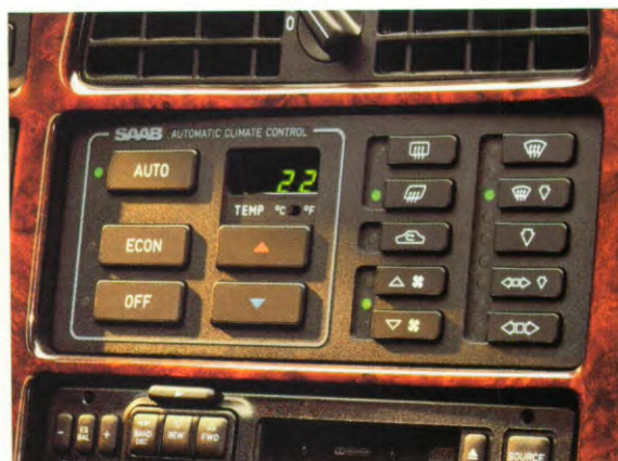
AUTOMATISCH KLIMAATBEHEERSINGSSYSTEEM (ACC). Zorgt dat de door u gewenste temperatuur wordt gehandhaafd. Regelt ook het ontdooien en ontwasemen. Natuurlijk bevat het systeem geen cfk's.
