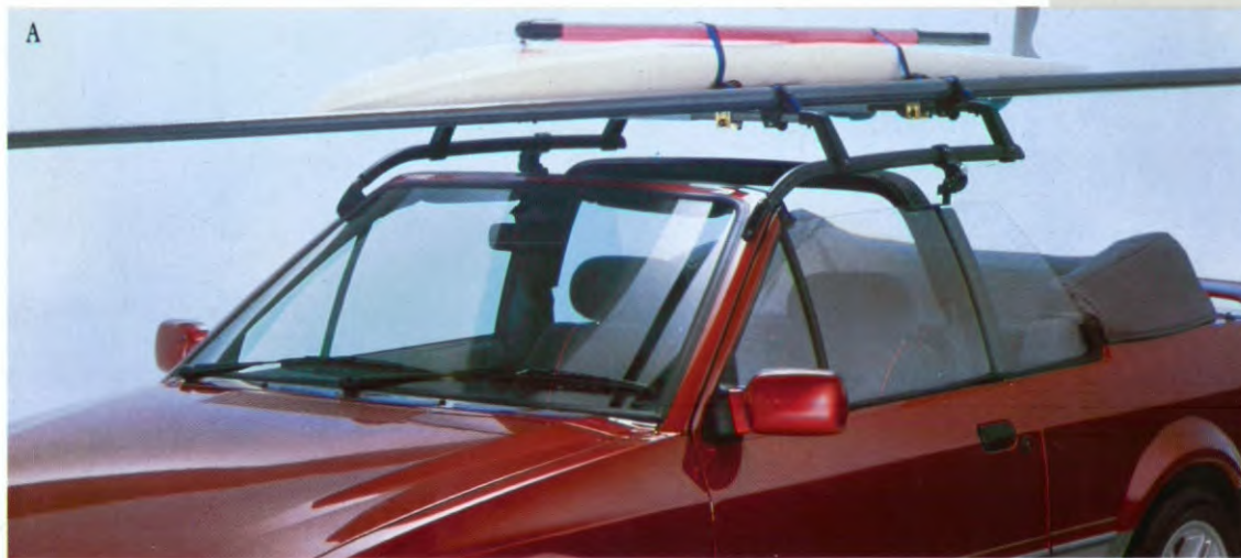
A Daktransportsysteem voor Cabriolet Speciaal voor cabriolet ontworpen afsluitbaar daktransportsysteem
