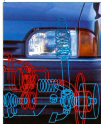
Speciaal anti-blokkerremsysteem voor wagens met voorwielaandrijving
