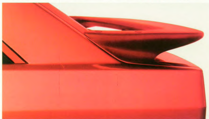
De markante achterspoiler zorgt voor de nodige neerwaartse druk bij hoge snelheden.
