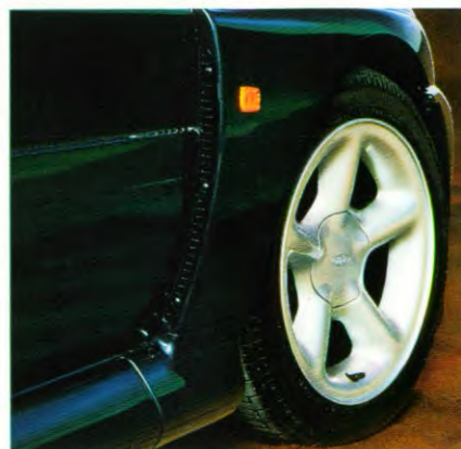
Boven: De luchtuitstroomopeningen in de voorspatschermen dragen bij aan de afkoeling van de motor.
