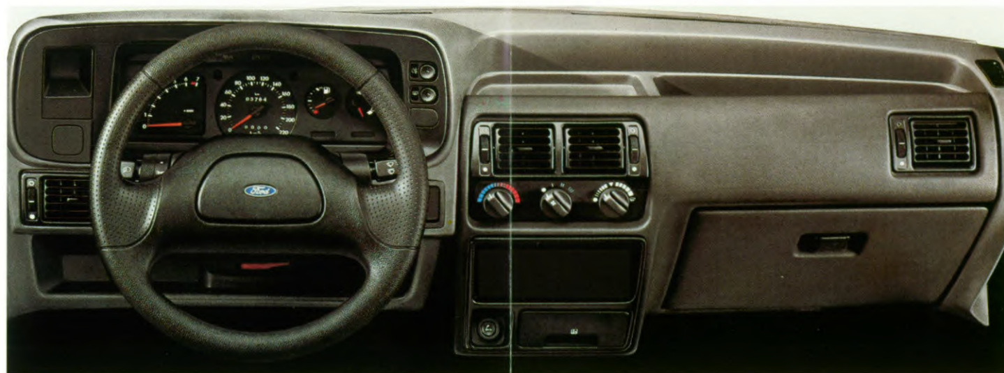
Sportstuurwiel en instrumentenpaneel met o.a. een toerenteller.
