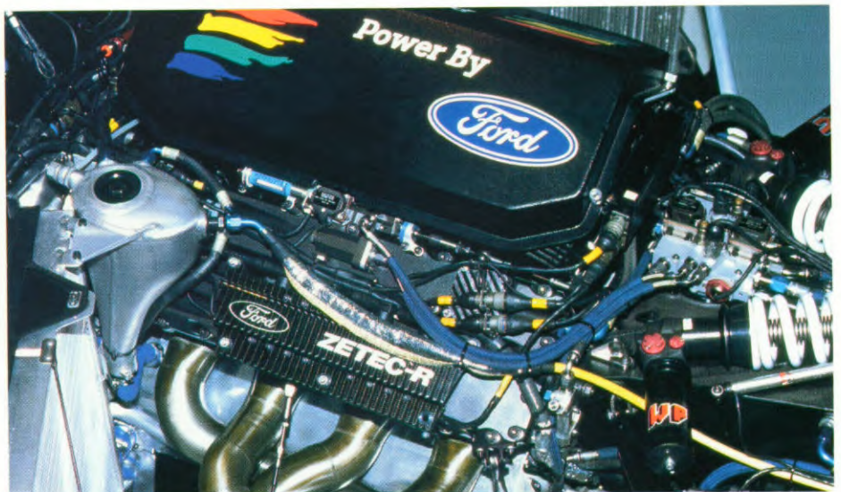
Ford ZETEC-R Formule 1-motor.
