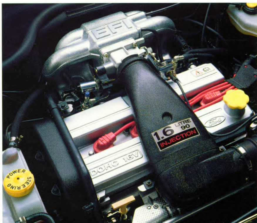
Vier kleppen per cilinder leveren een hoog koppel over een breed toerengebied. 90% van het maximale koppel wordt bereikt tussen 2300 en 6300 toeren per minuut.
