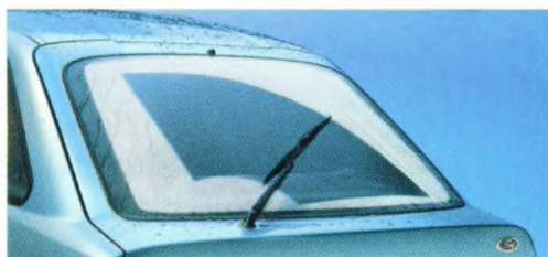
Wis/was-installatie op de achterraut.
