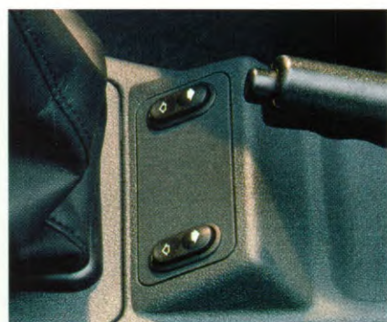
Elektrisch bedienbaar voorportierraam aan bestuurderszijde door één druk op de knop volledig te openen.
