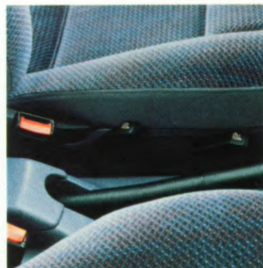
De verstelhendels zitten aan de zijkant van de stoel zodat u bij wijzigingen in een natuurlijke rijpositie kunt blijven zitten.
