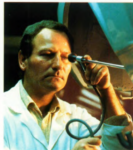
Controle van een holle ruimte de behandeling met anti-roest was.
