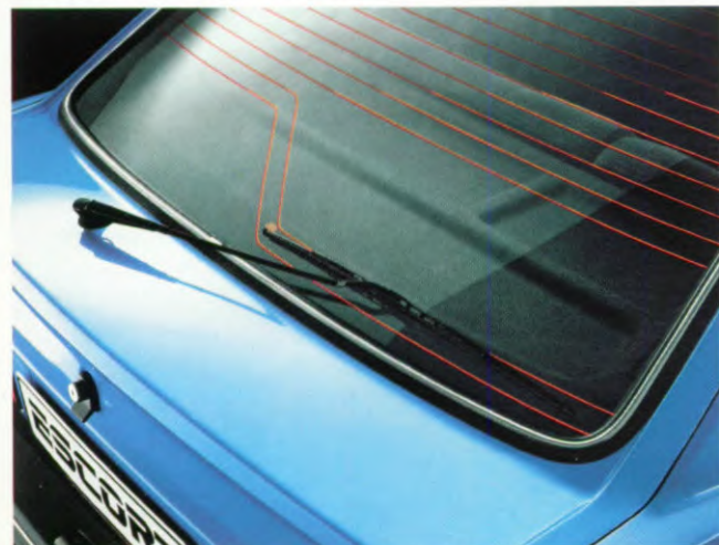
Radio-antenne in verwarmingselement, wis-was installatie.
