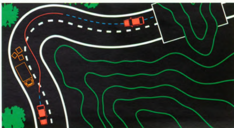
Het als optie leverbare anti-blokkerremstelsysteem (ABS) draagt ertoe bij dat de auto bij een noodstop normaal bestuurbaar blijft.
